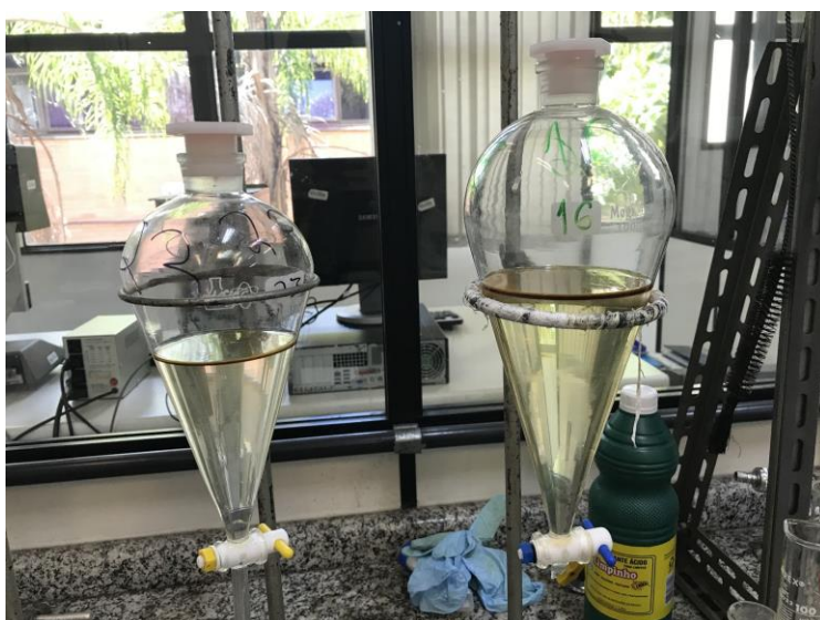
Figuras 13 e 14 – Aspecto da mistura reacional após a adição de fenolftaleína; amostras lavadas em decantação.
