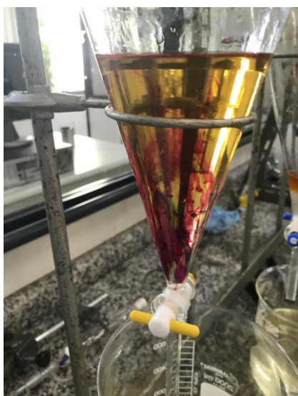
Figuras 13 e 14 – Aspecto da mistura reacional após a adição de fenolftaleína; amostras lavadas em decantação.
