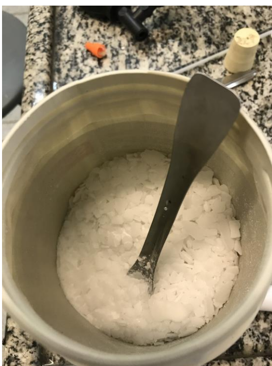
Figura 10 – Aspecto heterogêneo da soda cáustica comercial utilizada.
